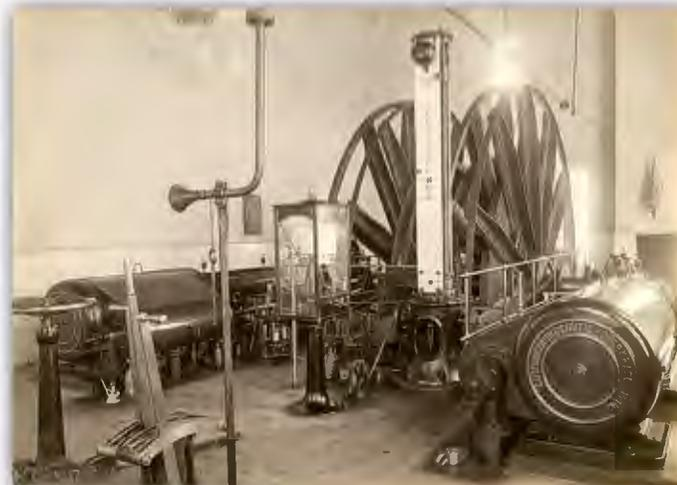
Máquina de Extracción a vapor GUTEHOFFNUNGSHÜTTE STERKRADE, 1914
